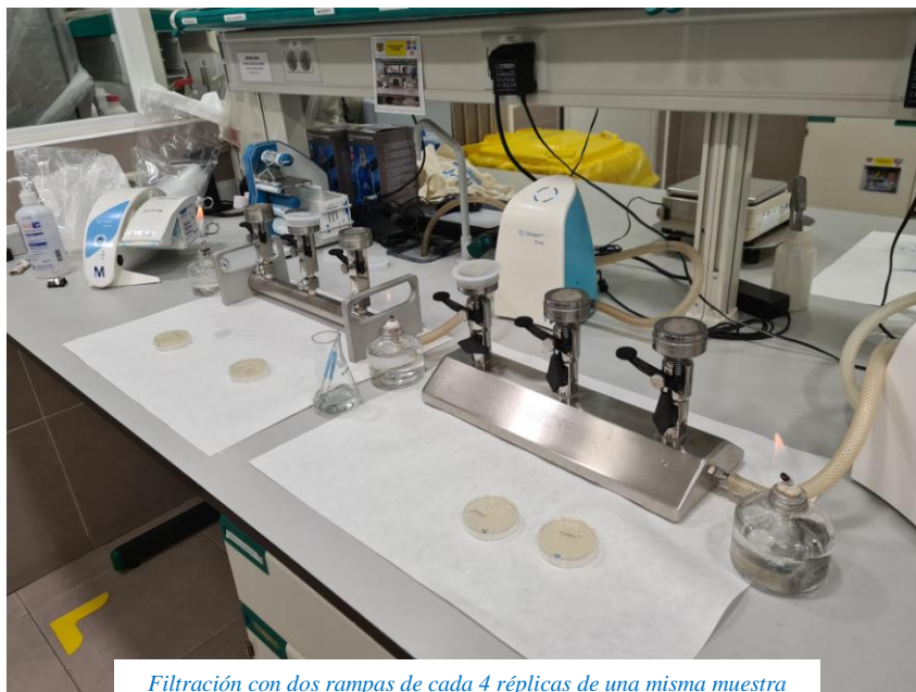
Filtración con dos rampas de cada 4 réplicas de una misma muestra
